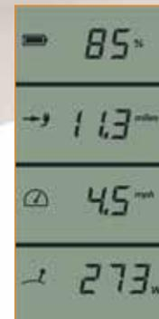
**+ Palanca de acelerador electrónico de progresión continua con pantalla del ordenador de a bordo,** que proporciona en todo momento los datos relativos a la carga de baterías, velocidad GPS, consumo y autonomía restante
